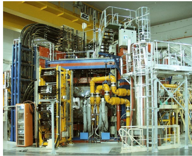
Tore Supra, CEA Cadarache 1988 NbTi TF coils 1.8K
